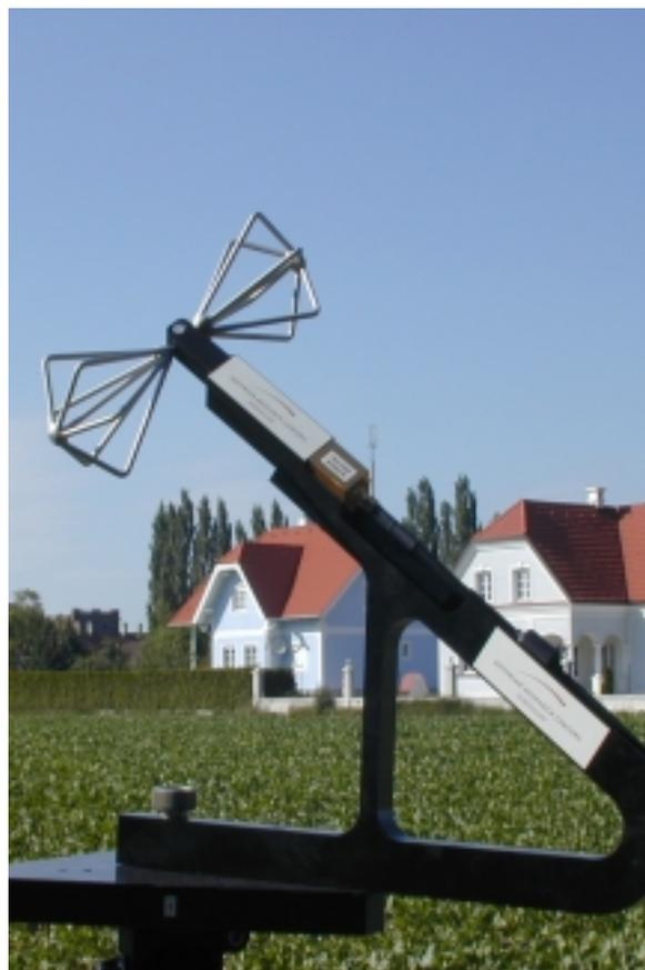
Abb. 1: Frequenzselektive Feldstärkemessung
